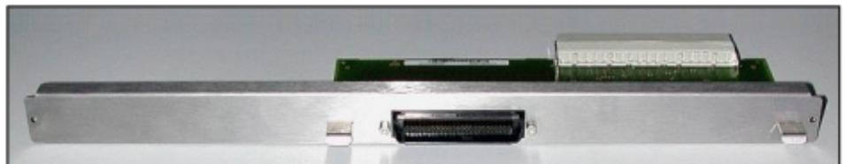
**Anschluss-Panel mit 24 RJ45-Buchsen (NPPAB, S30807-Q6622-X)**
